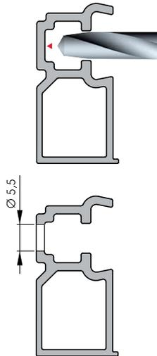
TRIADE INSERTION INTO THE ALUMINIUM PROFILE
